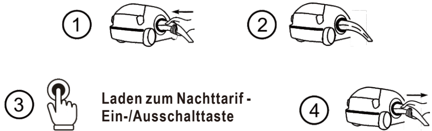
Bedienablauf des Sofortladebetriebs
