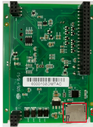
Micro-SD-Einschub der 22-kW-Ladestation
